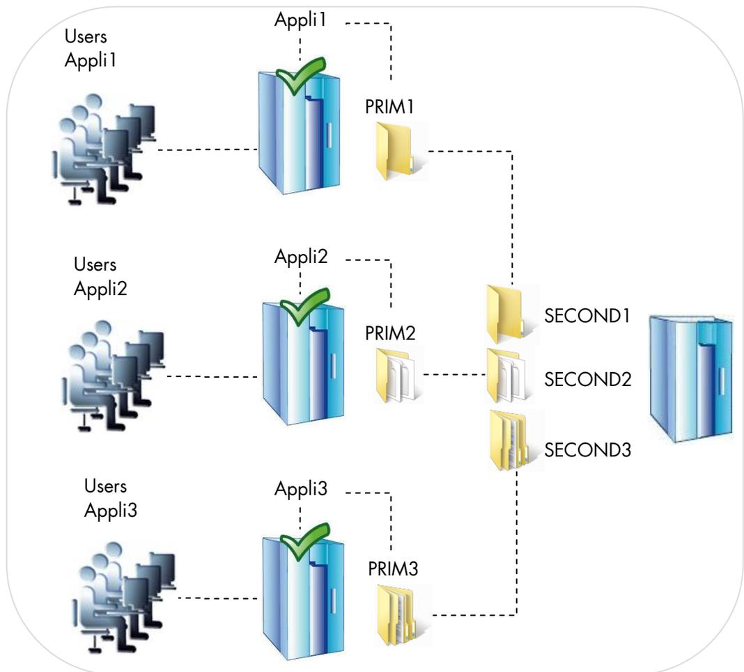
如果N个Active服务器中的一个发生故障，单独的备份服务器重新启动失效服务器的模块。问题立刻被解决，故障服务器被重新启动，应用程序转回到其原来的服务器上。
