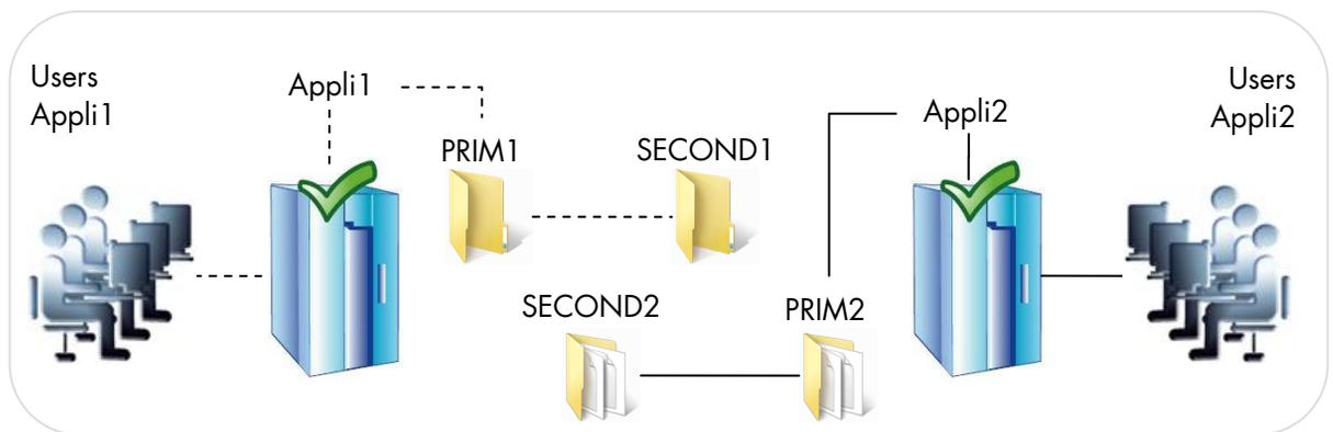
在 Active/Active 集群中，如果一个服务器失效，所有的应用程序将会在同样的物理服务器上被激活。当失效的服务器重新启动后，应用程序会返回缺省的主服务器。
