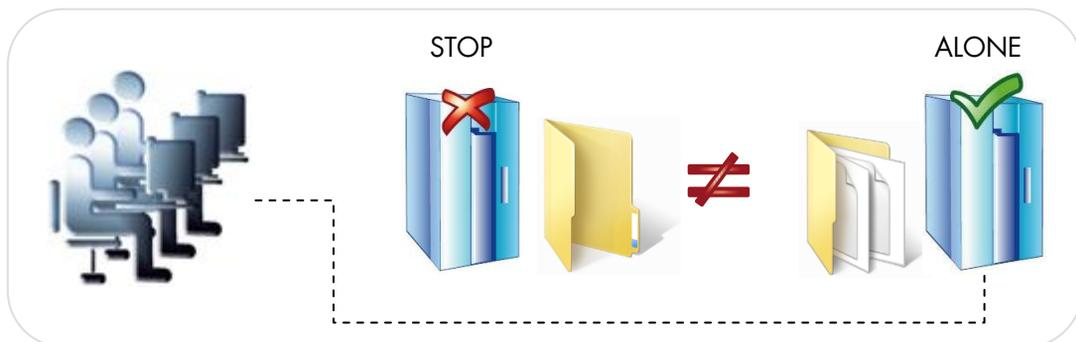
当第一台服务器失效时，第二台服务器接管工作。SafeKit自动切换集群的虚拟IP地址并在第二台服务器上重新启动应用。多亏两台服务器的同步复制，应用程序可以在第二台服务器上找到SafeKit最新的复制过的文件。应用程序在本地修改它的文件，继续在第二台服务器上运行，而不需要在第一台服务器上复制。
