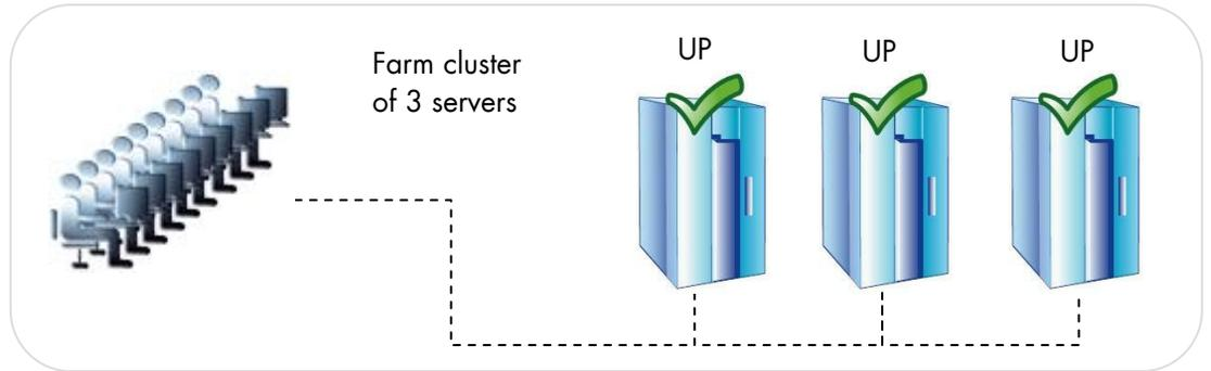
Farm 软件集群通过透明的网络流量分配提供网络负载均衡，软硬件失效备援。架构为增加系统负载提供了一个简单的方案。
